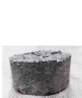
Figuras 2 - 4. Briquetas de aluminio residual y cestas de titanio empleadas para la descontaminación del agua residual mediante electrocoagulación.
