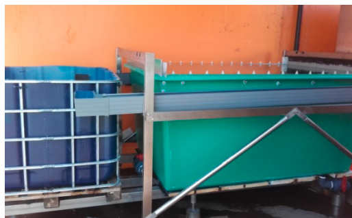
Figura 1. Unidad de electrocoagulación con electrodos de briquetas de aluminio (Volumen=2200 L).
