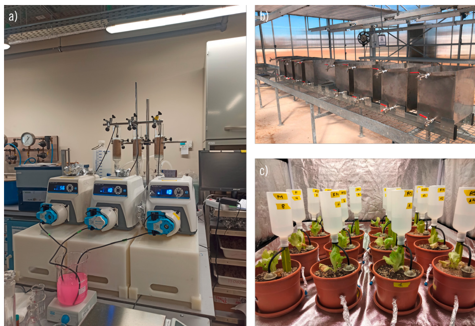
Partes de un equipo experimental para ensayos a) en columna, b) sistemas de escorrentía-infiltración, y c) bioensayos
