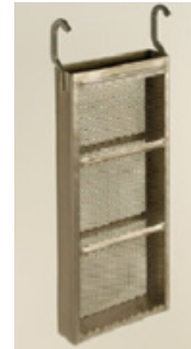
Figuras 2 - 4. Briquetas de aluminio residual y cestas de titanio empleadas para la descontaminación del agua residual mediante electrocoagulación.
