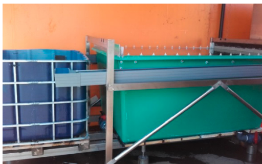
Figura 1. Unidad de electrocoagulación con electrodos de briquetas de aluminio (Volumen=2200 L).
