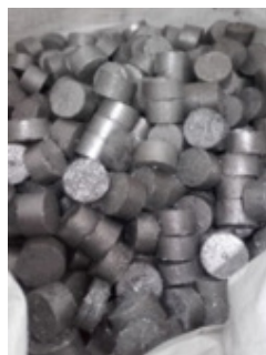
Figuras 2 - 4. Briquetas de aluminio residual y cestas de titanio empleadas para la descontaminación del agua residual mediante electrocoagulación.
